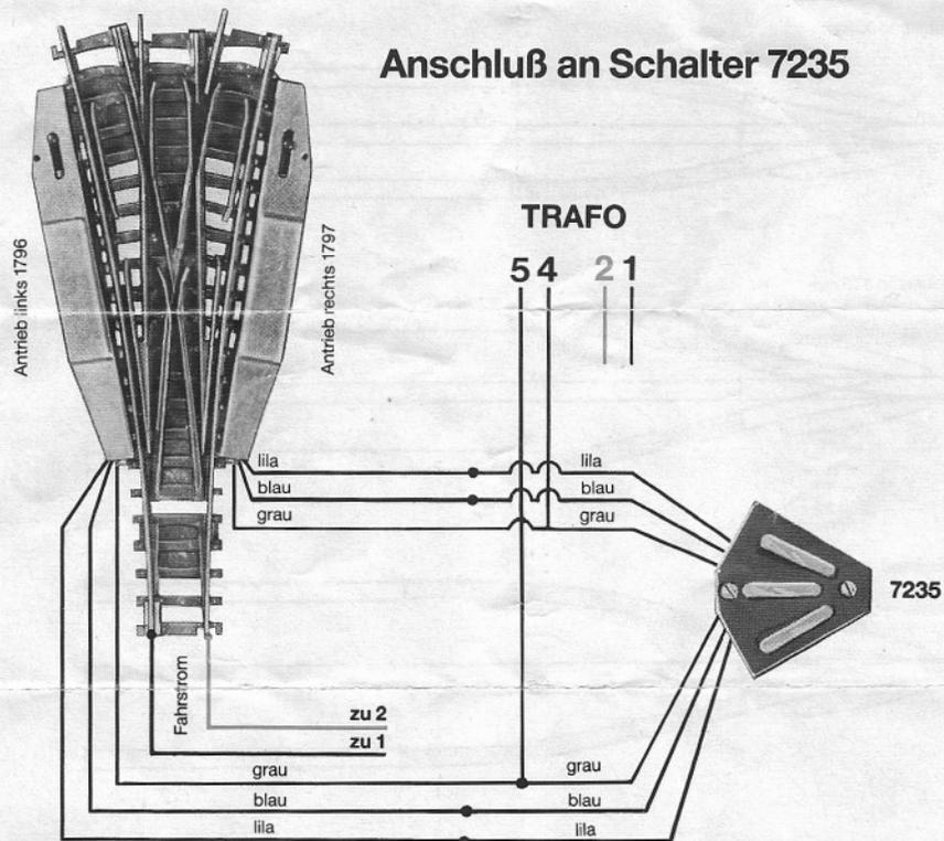
Beim Schalten des Dreiwegweichenschalters 7235 empfehlen wir -wenn z.B. von Rechtsfahrt nach Linksfahrt geschaltet werden soll- zuerst die Mitteltaste und anschließend erst die Linkstaste zu betätigen.
